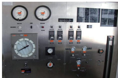
图1 ARJ21飞机环控功能试验手动控制台照片
